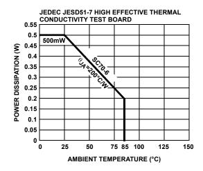
FIGURE 2. PACKAGE POWER DISSIPATION vs AMBIENT TEMPERATURE
